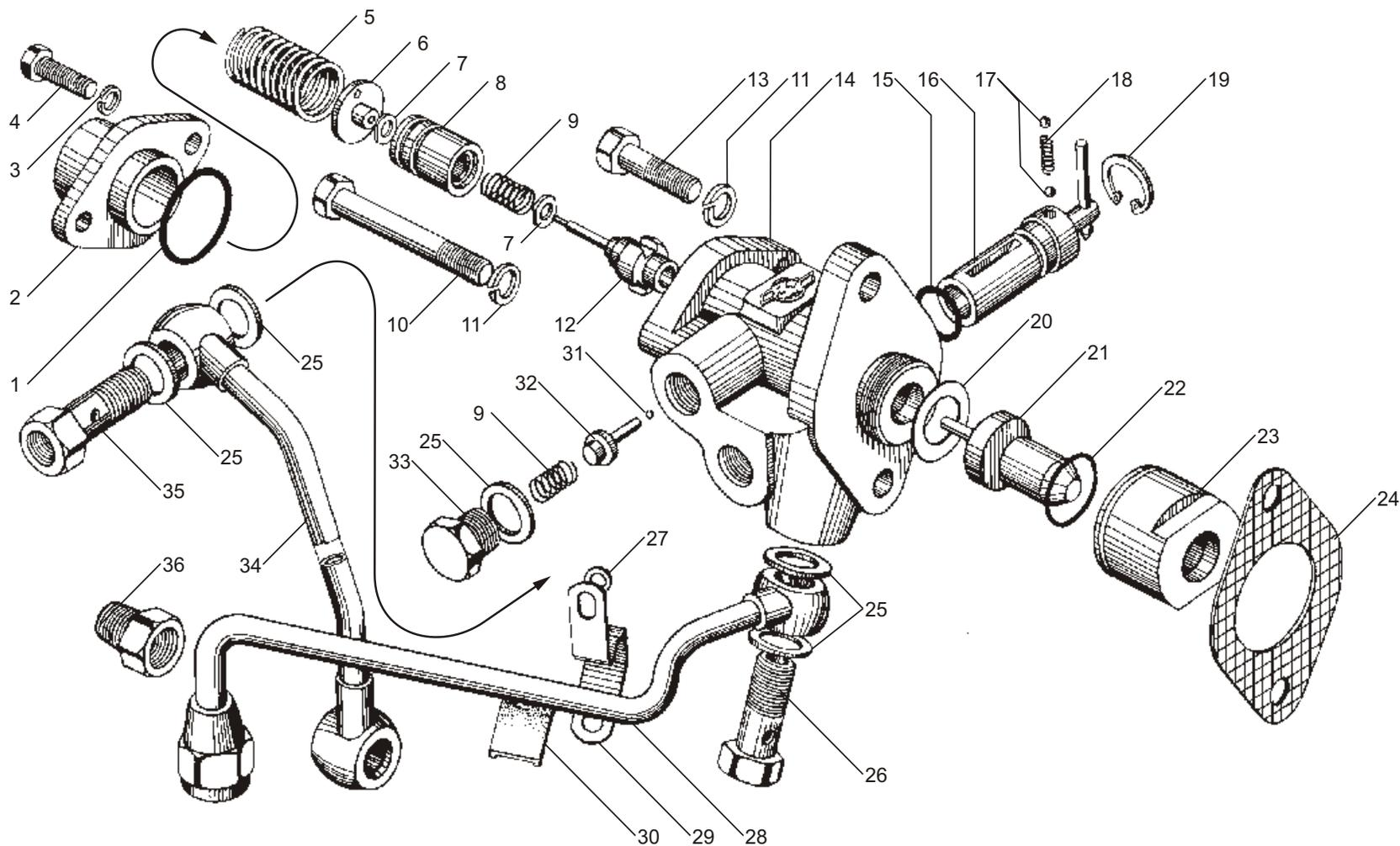
Рис. 35 ВКЛЮЧАТЕЛЬ МУФТЫ ПРИВОДА ВЕНТИЛЯТОРА ДВИГАТЕЛЯ ЯМЗ-238НД5
