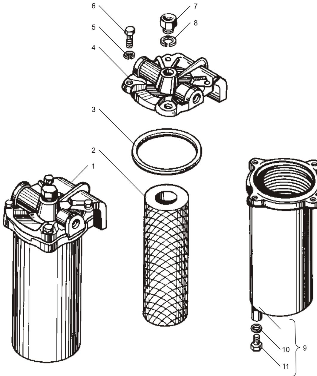
Рис. 17 ФИЛЬТР ГРУБОЙ ОЧИСТКИ ТОПЛИВА
