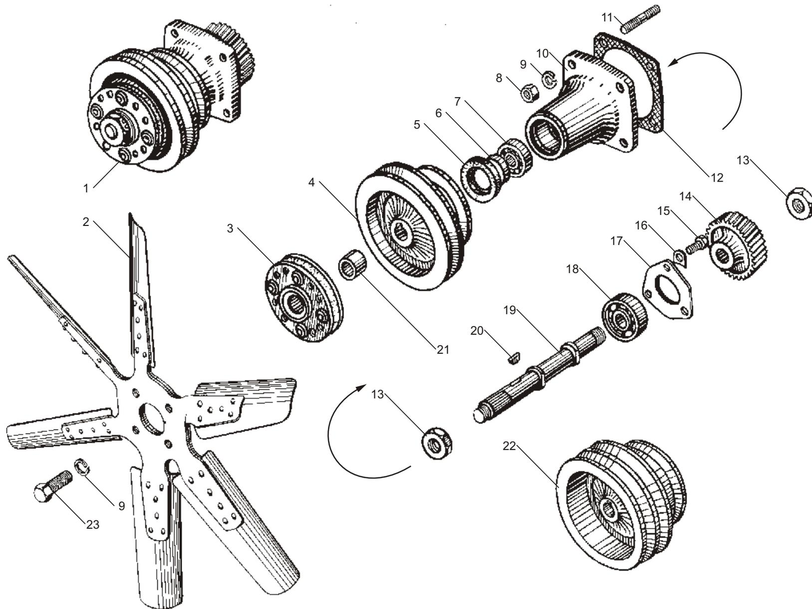
Рис. 33 ВЕНТИЛЯТОР И ПРИВОД ВЕНТИЛЯТОРА ДВИГАТЕЛЕЙ ЯМЗ-238НДЗ И ЯМЗ-238НД4
