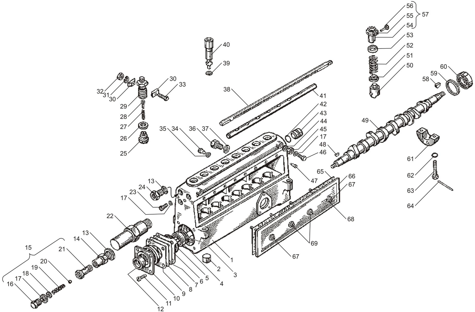
Рис. 22 ТОПЛИВНЫЙ НАСОС ВЫСОКОГО ДАВЛЕНИЯ
