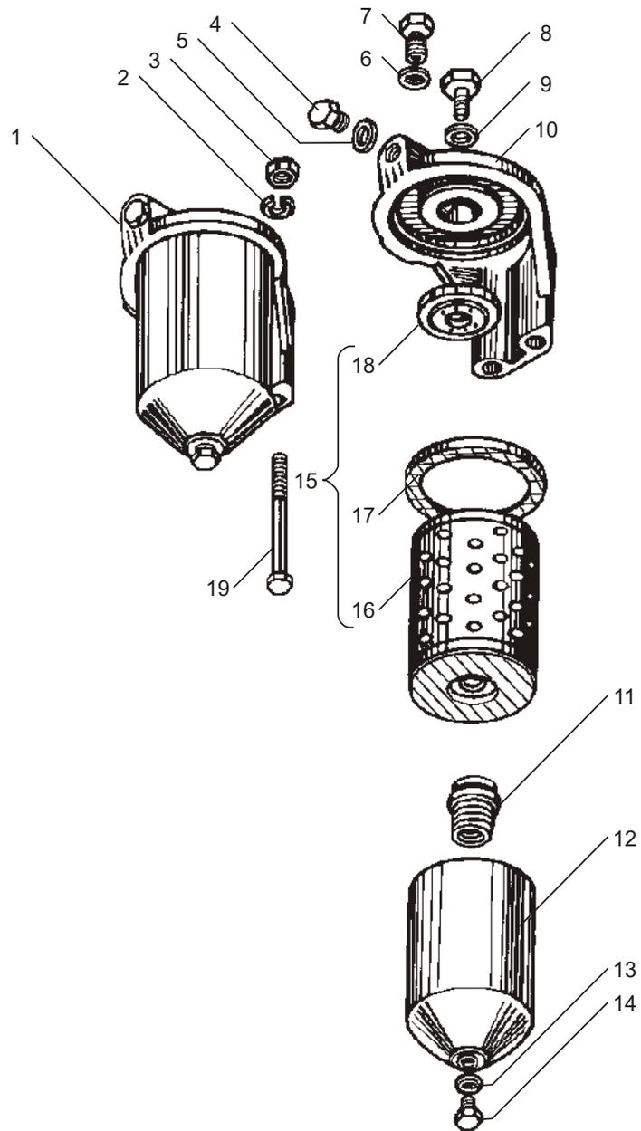
Рис. 25 ФИЛЬТР ТОНКОЙ ОЧИСТКИ ТОПЛИВА
