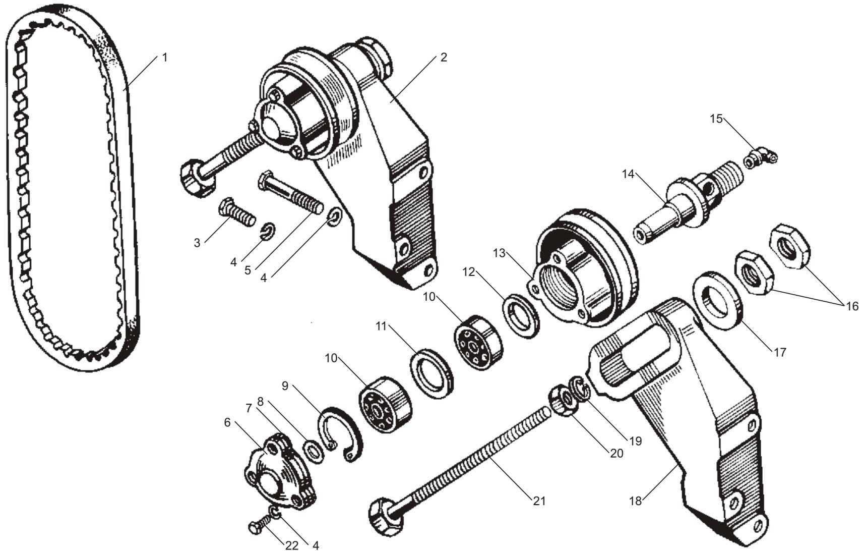
Рис. 36 УСТРОЙСТВО НАТЯЖНОЕ
