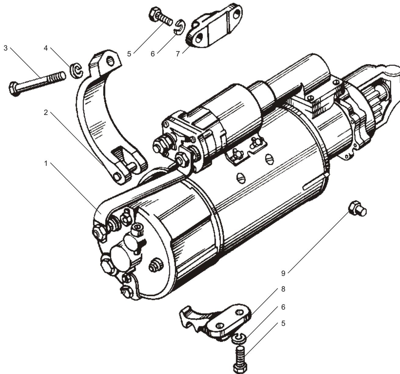
Рис. 41 СТАРТЕР В СБОРЕ И ЕГО КРЕПЛЕНИЕ
