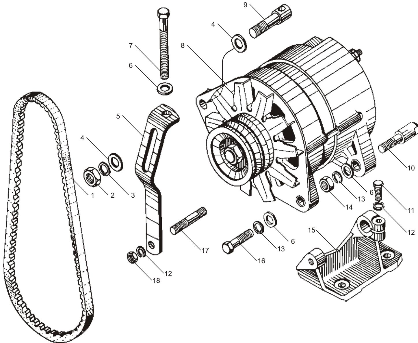
Рис. 38 ГЕНЕРАТОР 5702.3701-30 В СБОРЕ И ЕГО КРЕПЛЕНИЕ
