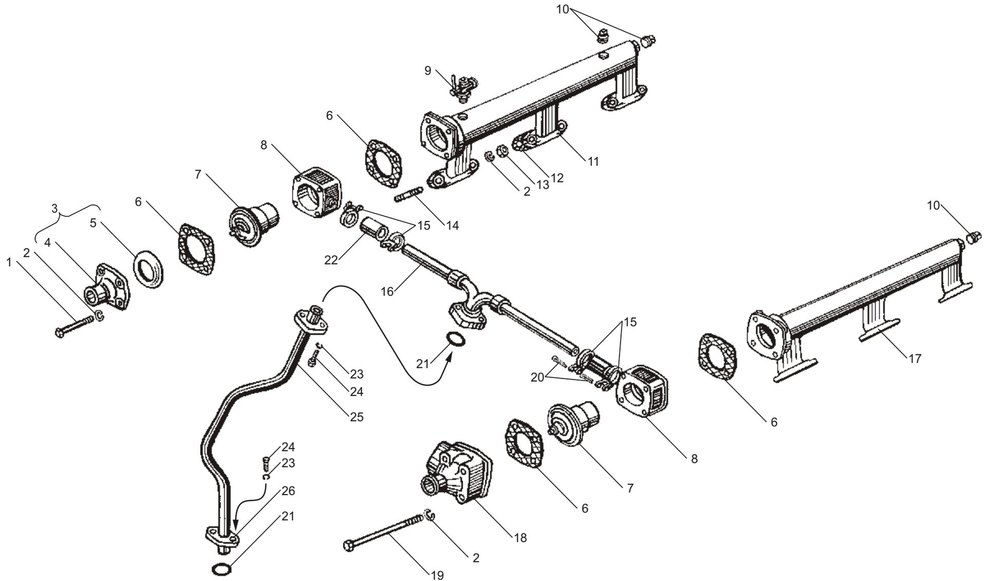
Рис. 30 ВОДЯНЫЕ ТРУБЫ И ТЕРМОСТАТЫ СИСТЕМЫ ОХЛАЖДЕНИЯ ДВИГАТЕЛЯ ЯМЗ-238НД5
