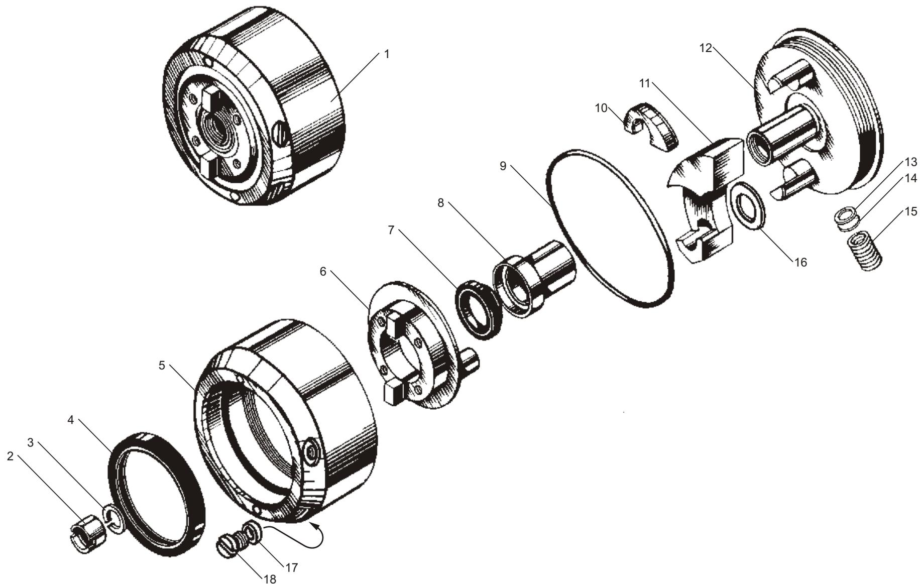
Рис. 28 МУФТА ОПЕРЕЖЕНИЯ ВПРЫСКИВАНИЯ ТОПЛИВА
