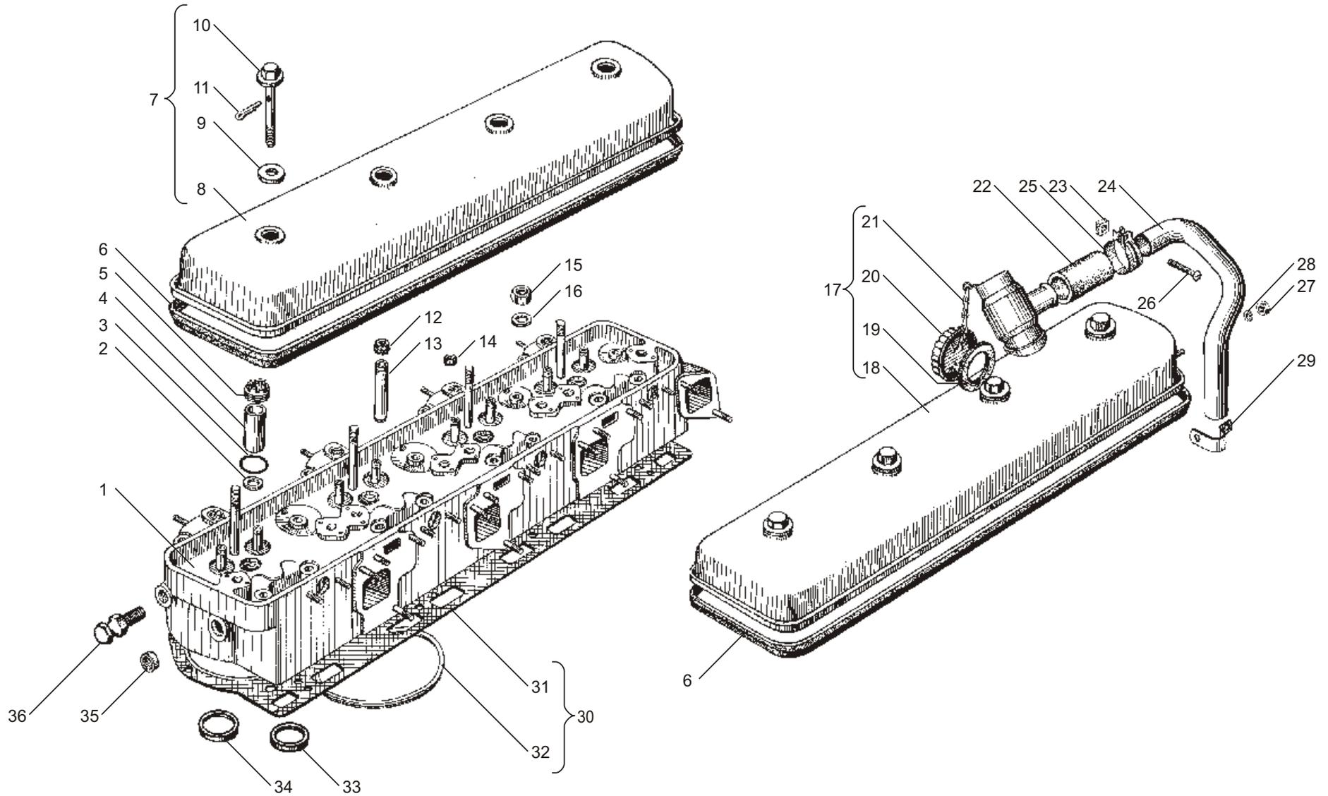
Рис. 4 ГОЛОВКА ЦИЛИНДРОВ
