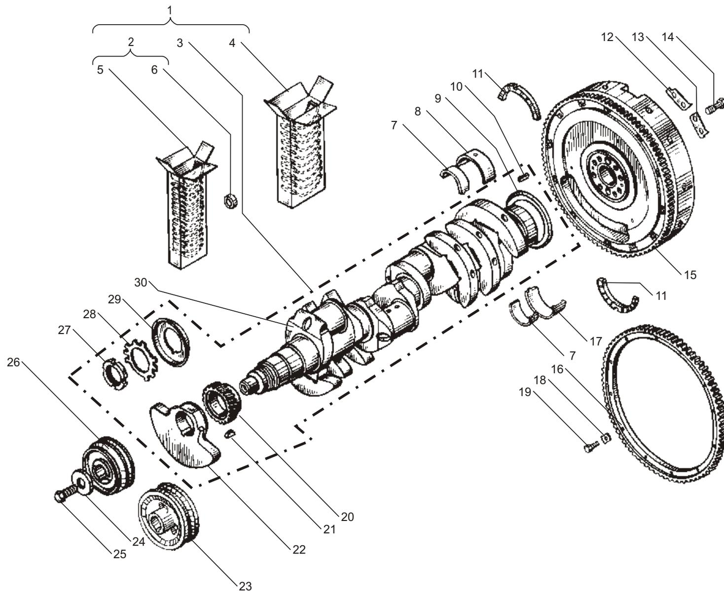
Рис. 6 ВАЛ КОЛЕНЧАТЫЙ И МАХОВИК
