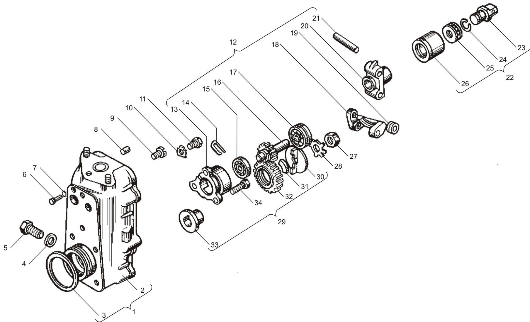
Рис. 19 КОРПУС РЕГУЛЯТОРА ЧАСТОТЫ ВРАЩЕНИЯ
