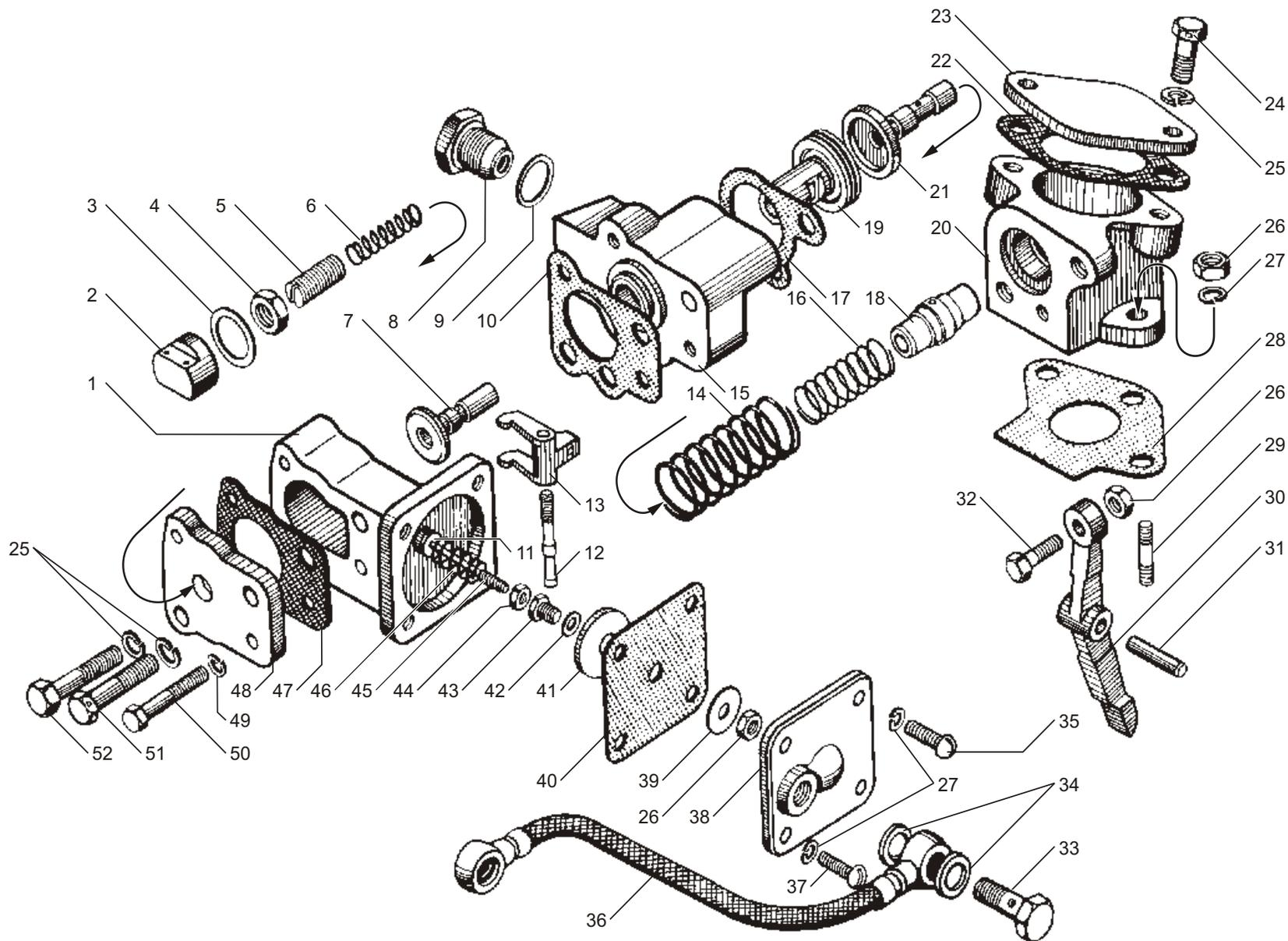
Рис. 21 КОРРЕКТОР ПОДАЧИ ТОПЛИВА ПО НАДДУВУ
