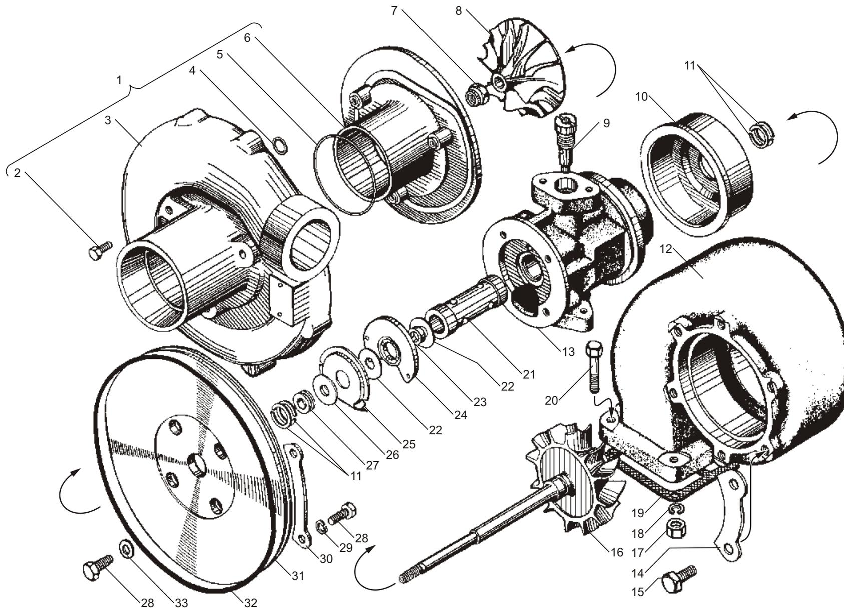
Рис. 26 ТУРБОКОМПРЕССОР
