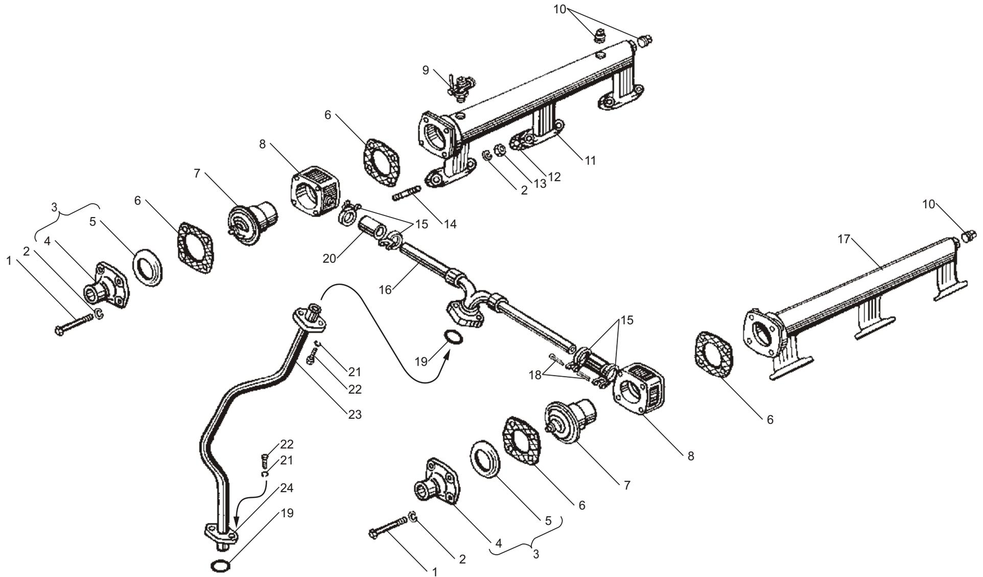
Рис. 29 ВОДЯНЫЕ ТРУБЫ И ТЕРМОСТАТЫ СИСТЕМЫ ОХЛАЖДЕНИЯ ДВИГАТЕЛЕЙ ЯМЗ-238НДЗ И ЯМЗ-238НД4
