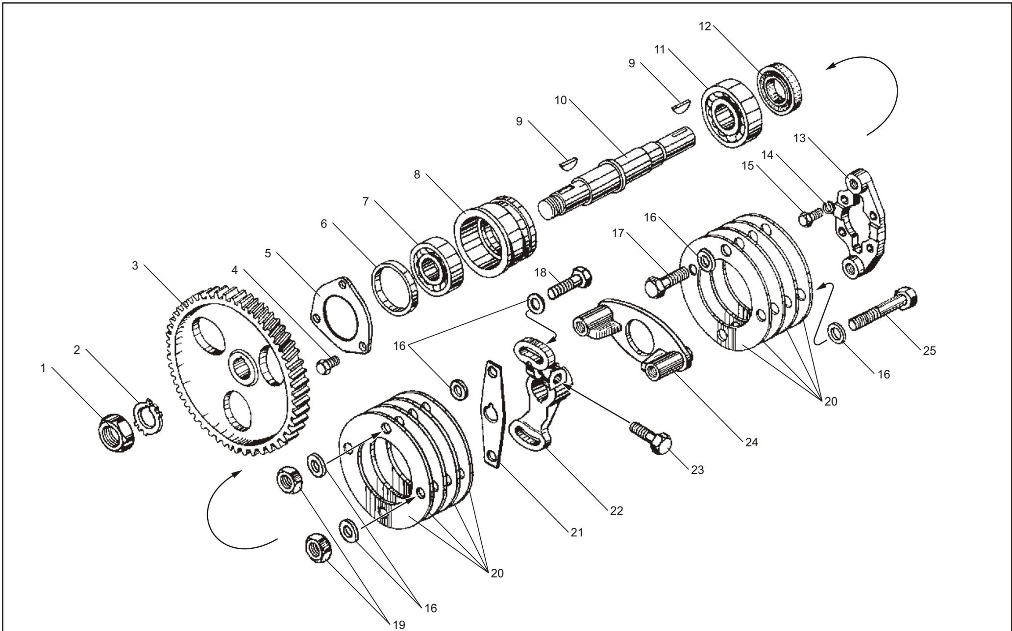
Рис. 15 ПРИВОД ТОПЛИВНОГО НАСОСА ВЫСОКОГО ДАВЛЕНИЯ
