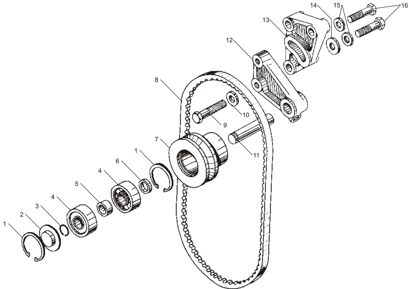
Рис. 32 НАТЯЖНОЕ УСТРОЙСТВО РЕМНЯ ПРИВОДА ВОДЯНОГО НАСОСА
