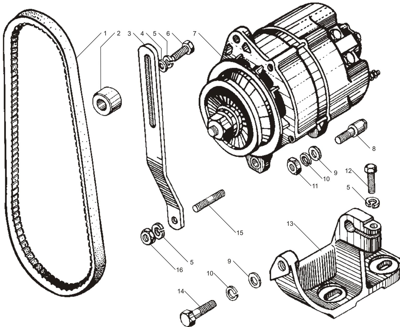
Рис. 37 ГЕНЕРАТОР В СБОРЕ, ЕГО КРЕПЛЕНИЕ И ПРИВОД
