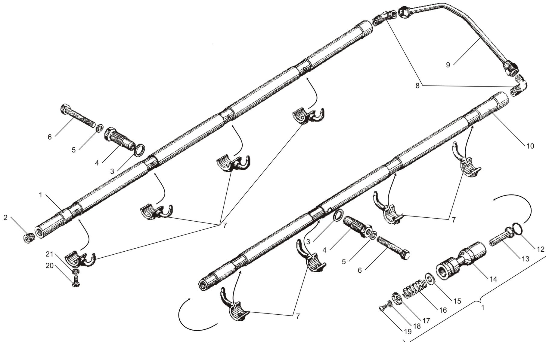
Рис. 11 СИСТЕМА ОХЛАЖДЕНИЯ ПОРШНЕЙ МАСЛОМ
