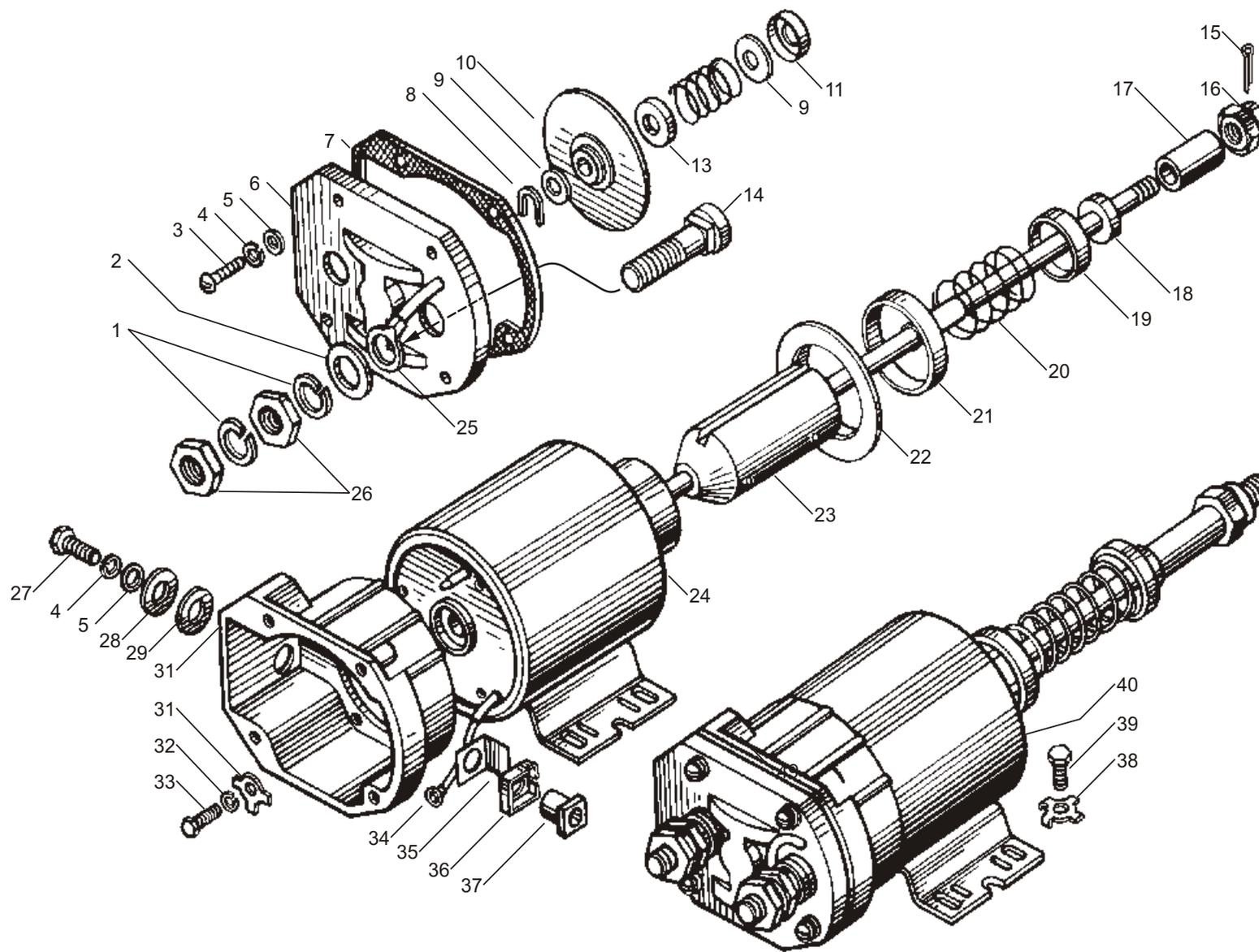
Рис. 43 РЕЛЕ СТАРТЕРА
