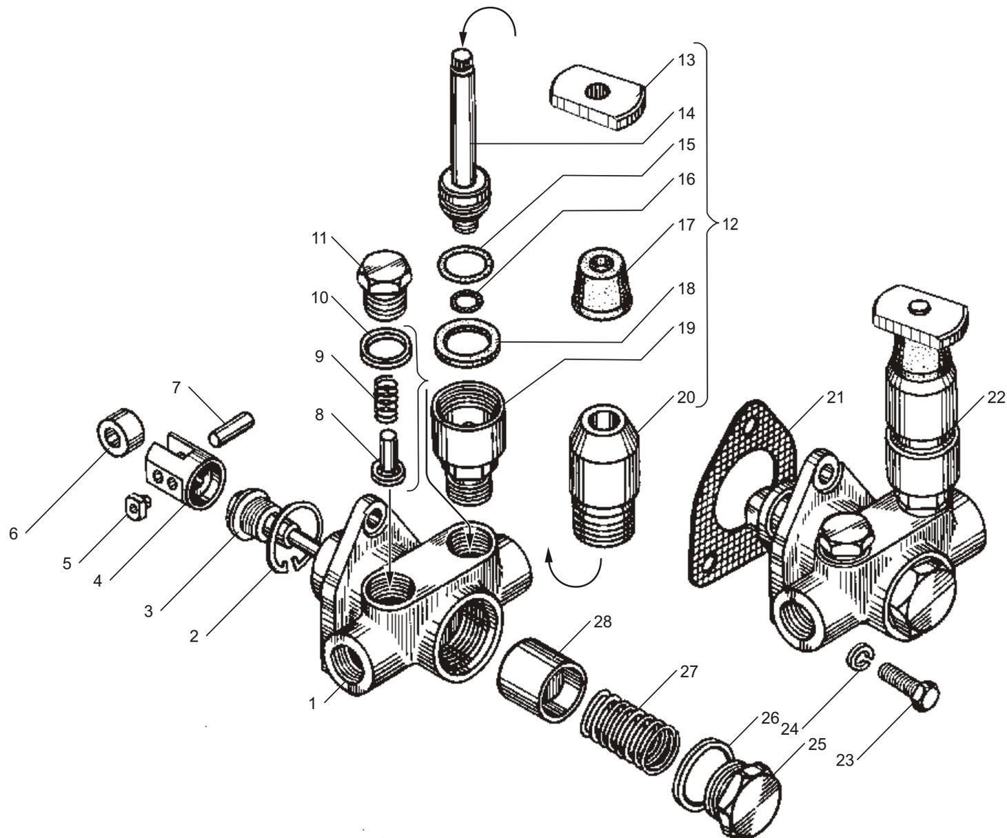
Рис. 18 НАСОС ТОПЛИВОПОДКАЧИВАЮЩИЙ
