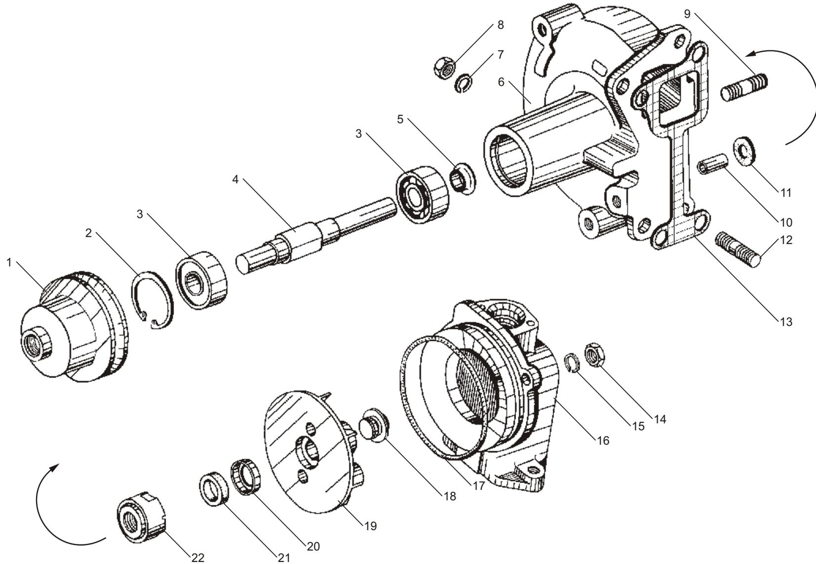
Рис. 31 ВОДЯНОЙ НАСОС
