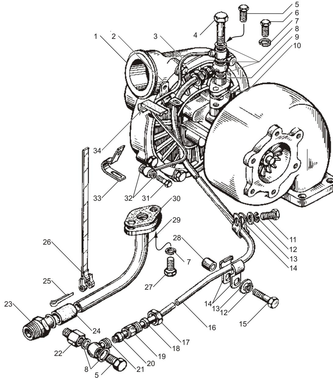
Рис. 27 ТРУБКИ ПОДВОДА И СЛИВА МАСЛА ТУРБОКОМПРЕССОРА
