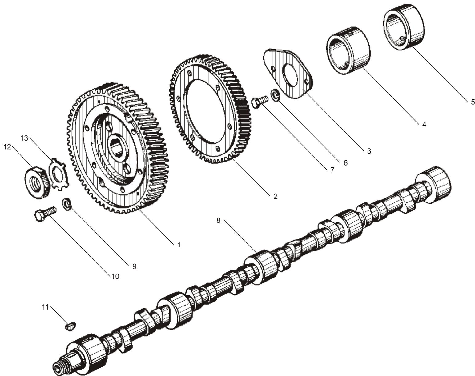
Рис. 7 РАСПРЕДЕЛИТЕЛЬНЫЙ ВАЛ
