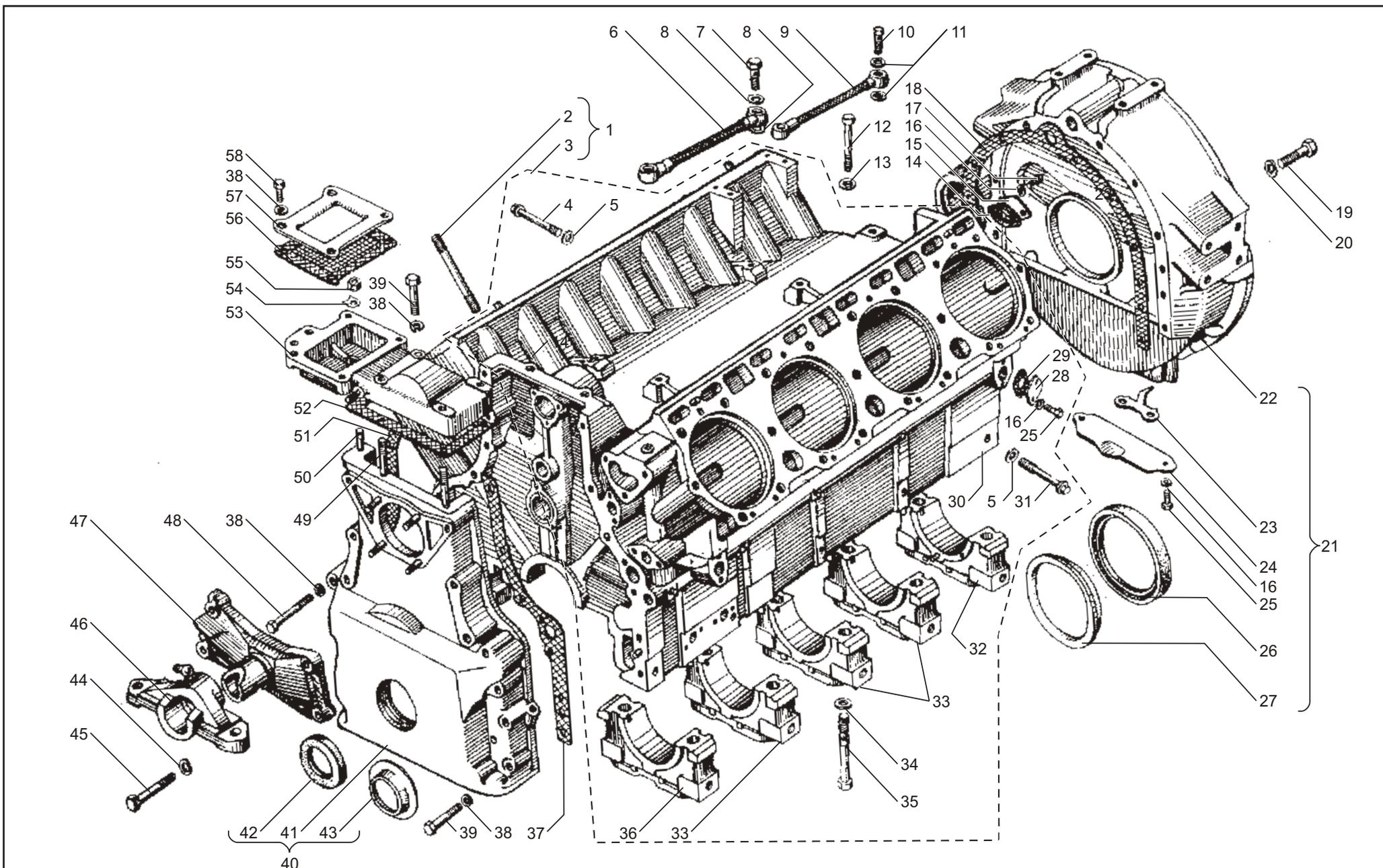
Рис. 3 БЛОК ЦИЛИНДРОВ
