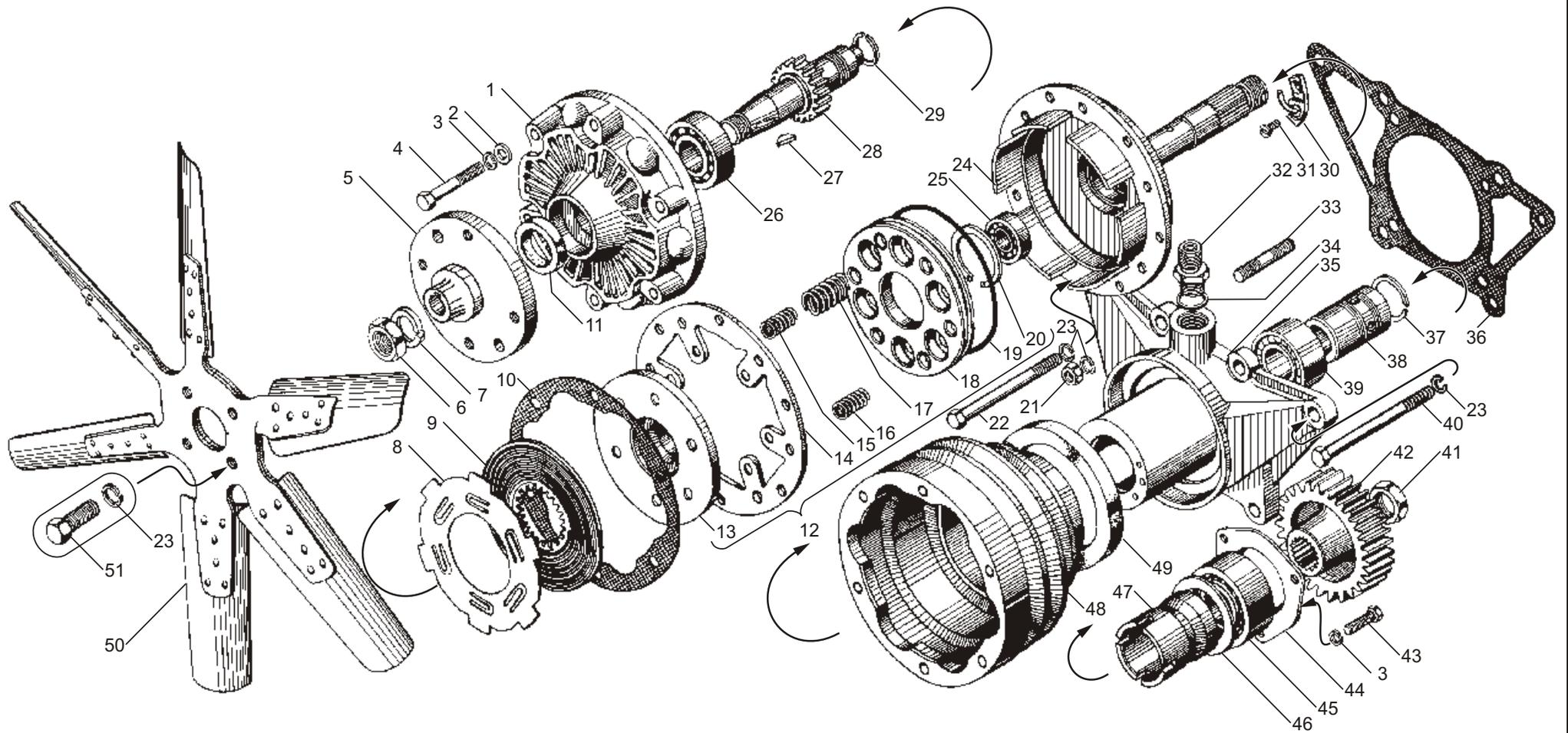
Рис. 34 ВЕНТИЛЯТОР И ПРИВОД ВЕНТИЛЯТОРА ДВИГАТЕЛЯ ЯМЗ-238НД5
