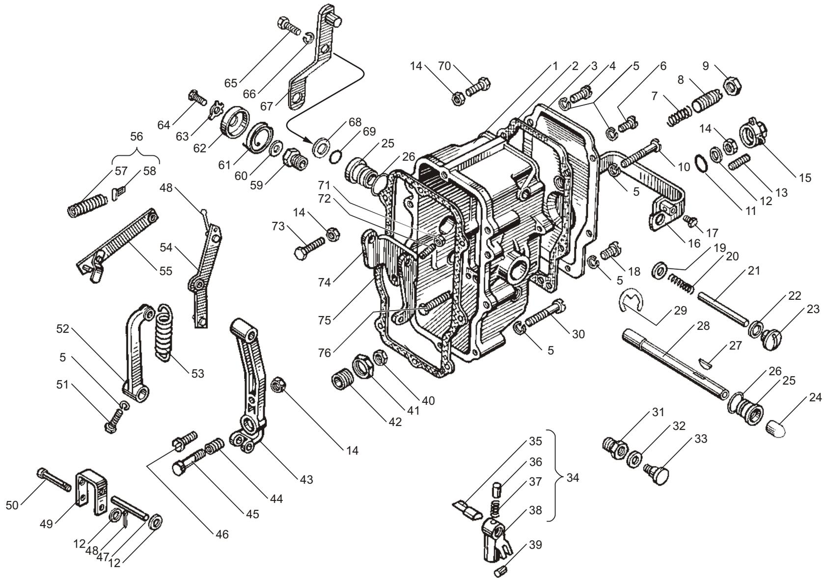
Рис. 20 РЕГУЛЯТОР ЧАСТОТЫ ВРАЩЕНИЯ
