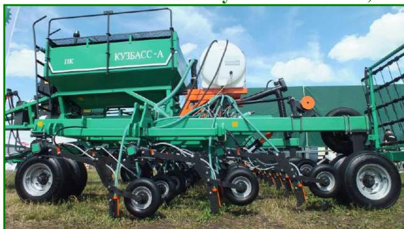
Посевной комплекс «Кузбасс-А» спроектирован таким образом, что часть веса бункера перераспределяется на заднюю ось трактора. В результате увеличивается сцепной вес трактора, снижается буксование, увеличивается маневренность агрегата, плавность хода машины в целом.
