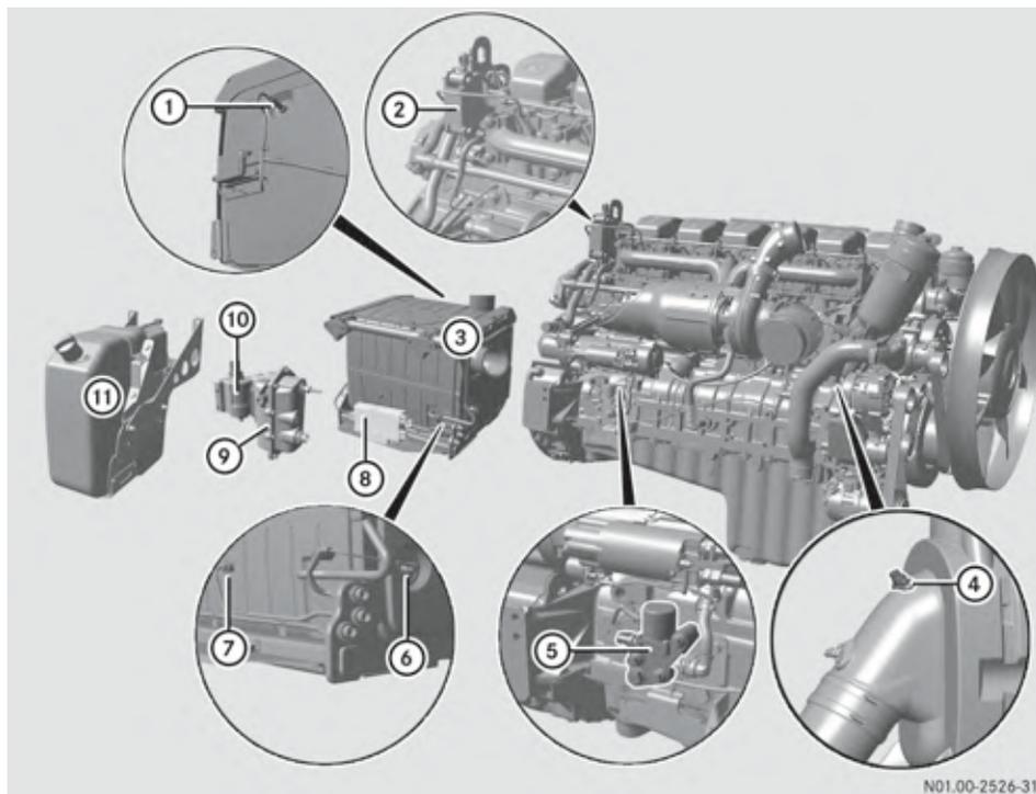
Общий обзор датчиков системы BlueTec®
