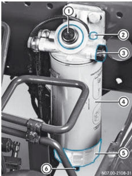
Фильтр предварительной очистки топлива (пример)
