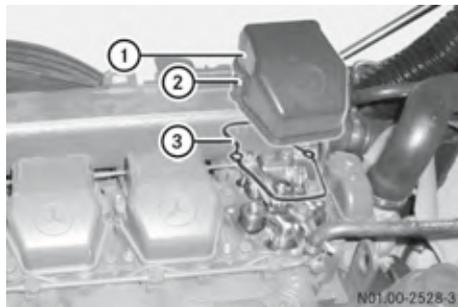
Крепление крышек головок блока цилиндров (пример)
