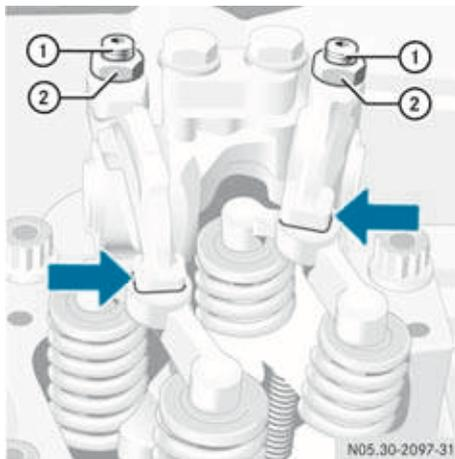
① Регулировочный винт
