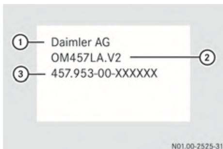
Заводская табличка двигателя для дорожных автомобилей (для движения по дорогам) (пример)
