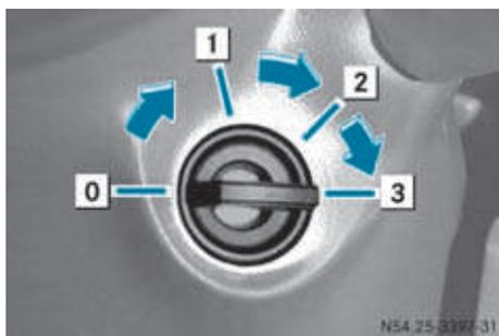
Замок зажигания (пример)
