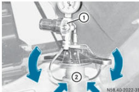
Специальный инструмент – контрольный манометр
