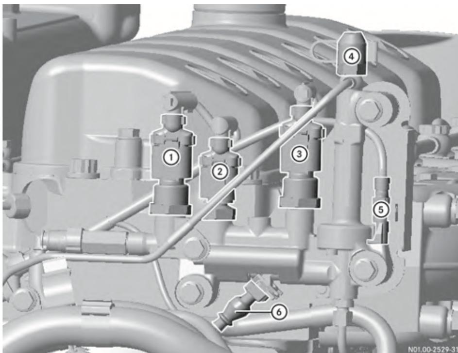
Датчики системы BlueTec® и контрольный патрубок на дозировочном устройстве
