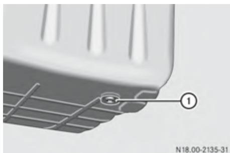
Резьбовая спускная пробка (пример)
