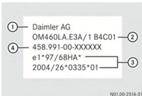
Заводская табличка двигателя для внедорожных автомобилей (для движения по бездорожью) (пример)
