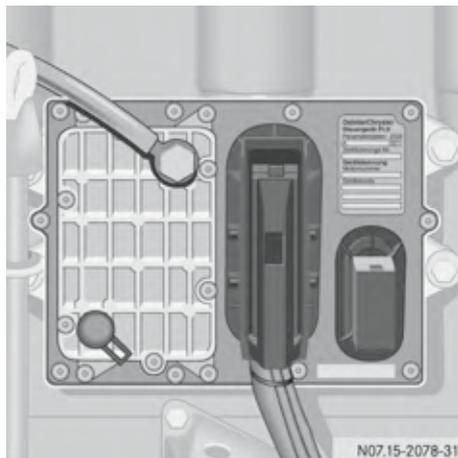
Блок управления системой регулирования двигателя (MR) (пример)
