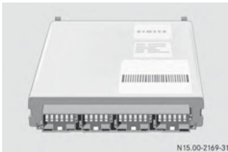
Блок управления системой FR (пример)
