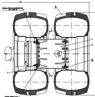
Для тракторов КИРОВЕЦ серии К-744Р разработана новая усиленная система сдвоивания колес. Ключевое отличие нового комплекта сдвоивания – использование жестко закрепленной на ступице вместе с внутренним колесом проставки-барабана, на которую установлено наружное колесо.
