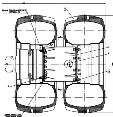
Для тракторов КИРОВЕЦ серии К-744Р разработана новая усиленная система сдвигания колес. Ключевое отличие нового комплекта сдвигания – использование жестко закрепленной на ступице вместе с внутренним колесом проставки-барабана, на которую установлено наружное колесо.
